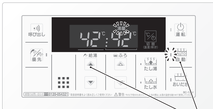
▲スイッチを1秒以上押しながら 自動 スイッチを押す。 ( 運転 スイッチ「入」、 自動 スイッチ「切」、通常表示状態で操作)
