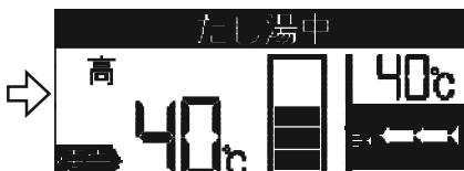
約 20L の湯はりが終了するとポンプのお湯を循環させて攪拌を行います。その後、浴槽の湯温がふろ設定温度より低い場合、引き続き追いだきを行います。
