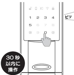
②[IC]に新たに登録するICカードをかざします。ICカードを読み込むと下図のようにテンキーが点灯します。
