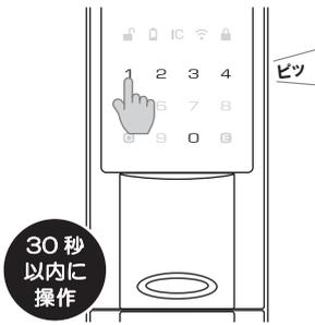
②[IC]に追加登録するICカードをかざします。ICカードを読み込むと下図のようにテンキーが点灯します。
