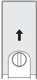
②矢印の方向に動かし、電池カバーを外します。
