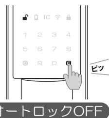
● オートロックOFFの場合、ドアをしめて[E]を押さずに10秒が経過すると[E]が消灯します。かぎを室外側からかける場合は、起動スイッチを押して[E]を点灯させてから[E]を押すとかぎがかかります。
