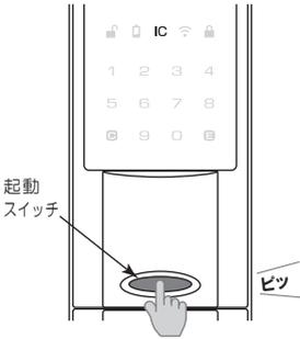
② [IC]にICカードをかざします。ICカードを読み込むと下図のようにテンキーが点灯します。
