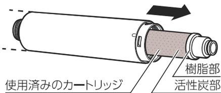
ヘッドをはずす際に、カートリッジがいつよについて出てきた場合は、カートリッジの樹脂部を持って引き抜いてください。活性炭部を持って引き抜くと樹脂部と分離してカートリッジが破損し、カートリッジの取り替えができなくなるおそれがありますのでご注意ください。
