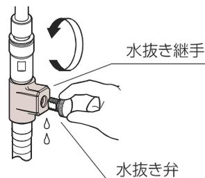
⑤水が完全に出なくなったら、図のように水抜き弁を取り付けます。
