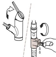
⑦水が完全に出なくなったら、水抜き弁を取り付けます。その後、レバーハンドルを止水状態にし、浄水器部を元に戻してください。
