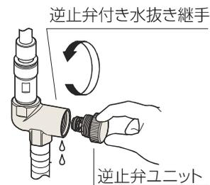
⑤水が完全に出なくなったら、図のように逆止弁ユニットを取り付けます。
