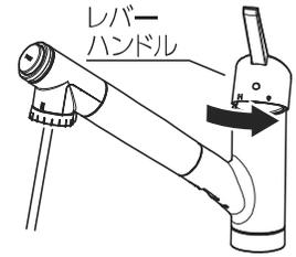
湯を使うときは、必ず水側から吐水し、ゆっくりお湯側に回し温度を調節してください。
