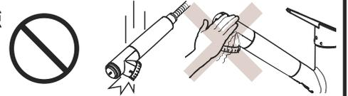
浄水器部に重い物を下げたり、力をかけて回したりしないでください。部品の破損の原因になります。
