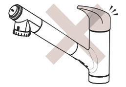
長期にわたるご使用により、部品が劣化・摩耗などで破損する可能性があります。定期的に(2回以上/年)キャビネット内や点検口内など、配管周りのガタツキや水漏れがないか確認してください。
