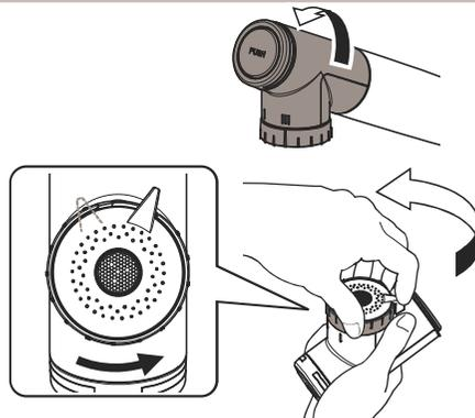
②シャワー/ストレーナ切替スクリーンが止まったら、ツメを持って矢印方向に回してスクリーンを取りはずします。
