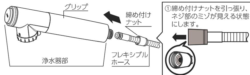
① 締め付けナットを引っ張り、ネジ部のミゾが見える状態にします。
