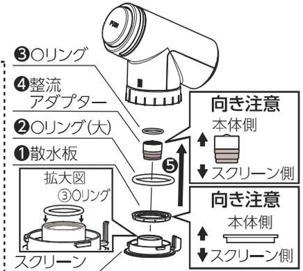
⑥スクリーンを手で押さえた状態でヘッドをひっくり返し、シャワー/ストレーナ切替スクリーンが止まるまで回します。
