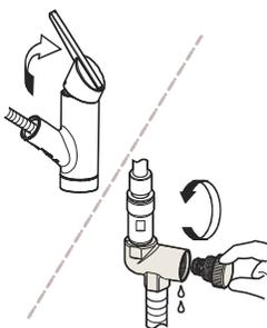
⑦水が完全に出なくなったら、図のように逆止弁ユニットを取り付けます。その後、レバーハンドルを止水状態にし、浄水器部を元に戻してください。
