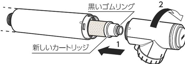
ヘッドの凹部をグリップの矢印に合わせてハメこんだあと、ヘッドのDマークをグリップのDマークに合うように回してください。
