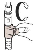
⑥レバーハンドルを上げたまま湯側いっぱいに戻した後、再び水抜き弁をはずし、フレキシブルホース及び水栓の水を十分に抜いてください。
