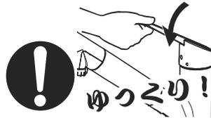
この水栓は、構造上左右に可動します。シンクより吐水口がはみ出す場合があります。ご使用の際は吐水口の位置を確認してから水を出してください。
