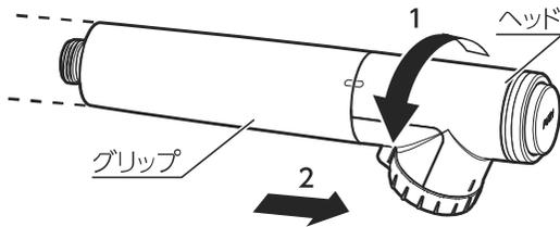
ヘッドのDマークが矢印の方向に動くようにヘッドを回してください。
