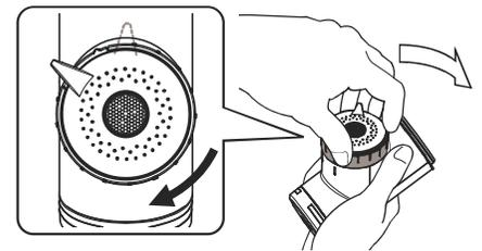
⑦シャワー/ストレーナ切替スクリーンが止まったら、スクリーンを押し込み、ツメを持って矢印方向に回します。
