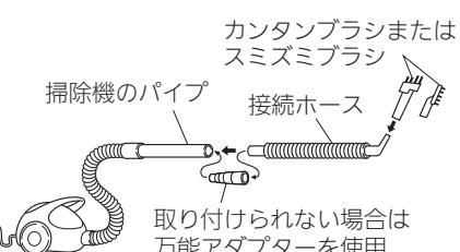
※万能アダプターは、掃除機のパイプ内径29.5~42.5(mm)に対応しています。
